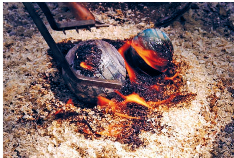
Bei 1000°C schmilzt die Glasur und die gebrannten Stücke können abgekühlt werden.
